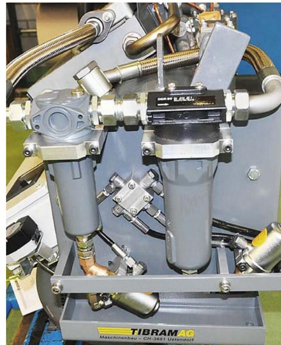
Kompressor mit montiertem Abscheiderpaket
