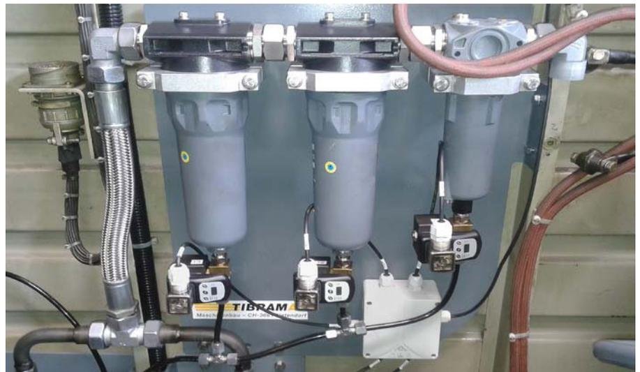
In der Lokomotive Re446 eingebautes Druckluftaufbereitungspaket
